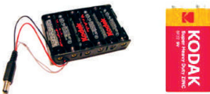
სურათი 2: 9 ვოლტიანი ბატარეა არდუინოსთვის კვების მისაწოდებლად.
